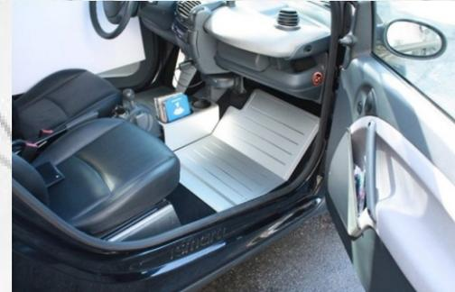
Matt eloxierte Aluminium-Oberfläche mit funktional gefräster Strukturillen.
