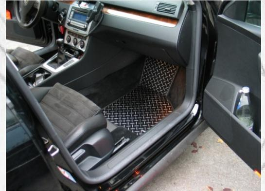
Pulverbeschichtete Aluminium-Oberfläche in matt-schwarzer Optik mit einwabiger Prägung mit freigeschliffener Oberfläche. (Sternchen-Optik).
